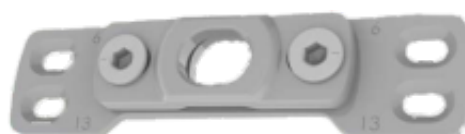
213104 Ответная планка дверного шпингалета Установка на алюминиевый порог Для осевого смещения 9/13 мм Регулировка прижима створки \pm 1 мм
